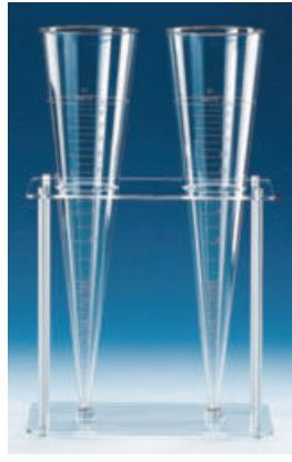
En PMMA/PP. Pour deux cônes de sédimentation d'Imhoff. Compact et facile à transporter, même avec les cônes pleins.
