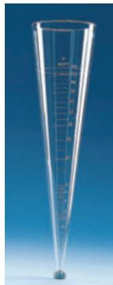
Norme DIN 12672. Transparent. Avec bouchon à vis pour écoulement du contenu. Résistance thermique jusqu'à max. + 85 °C.
