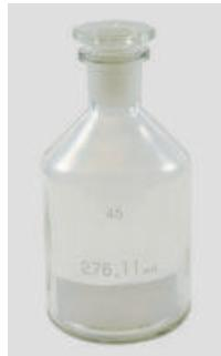
Selon Winkler. Pour la détermination de l'oxygène dissous dans l'eau. Le volume mesuré est indiqué à ±0,01 ml près. Surface de marquage blanche. Chaque flacon est ajusté avec le bouchon correspondant. Flacon et bouchon ne sont donc pas interchangeables. Pour éviter les erreurs, le flacon et le bouchon portent le même numéro.
