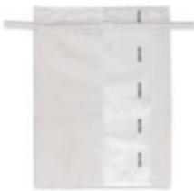
Pour collecter, transporter et analyser des échantillons liquides et solides. Système de fermeture sûr intégré avec 1 fil rond et 1 fil plat.
