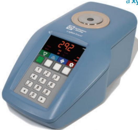
Appareil de mesure robuste tout automatisé avec échelle °Brix et compensation automatique de température à 20 °C selon ICUMSA pour des applications dans l'industrie des aliments, du sucre et des boissons. Le réfractomètre peut être connecté à une imprimante ou un PC de laboratoire et émettre les résultats de mesure dans les formats impression standard, CSV ou PDF sécurisé.
