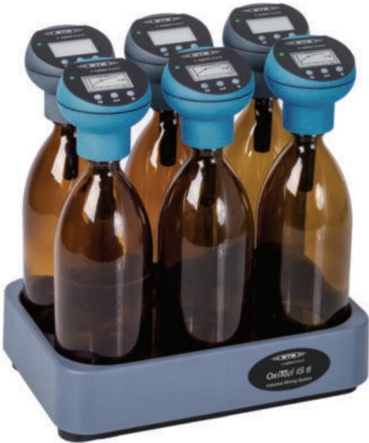
Système de mesure respirométrique facile à utiliser pour déterminer le besoin biologique en oxygène (DBO). La DBO peut être mesurée en même temps dans jusqu'à 6 ou 12 échantillons.
