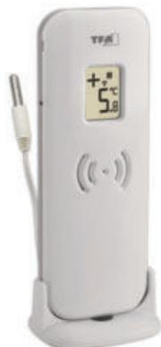
Thermomètre radiopiloté pour surveiller la température extérieure et l'ambiance intérieure avec température et humidité. La température extérieure est mesurée sans fil à l'aide de l'émetteur de température fourni. La portée est de 100 m avec une fréquence de transmission de 433 MHz. Jusqu'à 3 émetteurs de température peuvent être reliés à la station de base.
