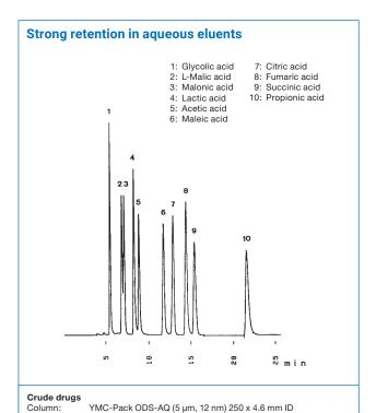
AQ12S05-2546WT 20 mM H<sub>3</sub>PO<sub>4</sub>-NaH<sub>2</sub>PO<sub>4</sub> (pH 2.8)
